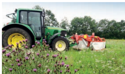
Klepelmaaiers met afzuiging blijken het meest schadelijk voor insecten, terwijl messenbalken en schijvenmaaiers (foto) zonder afzuiging een betere keuze zijn. Foto: Kars Veling
